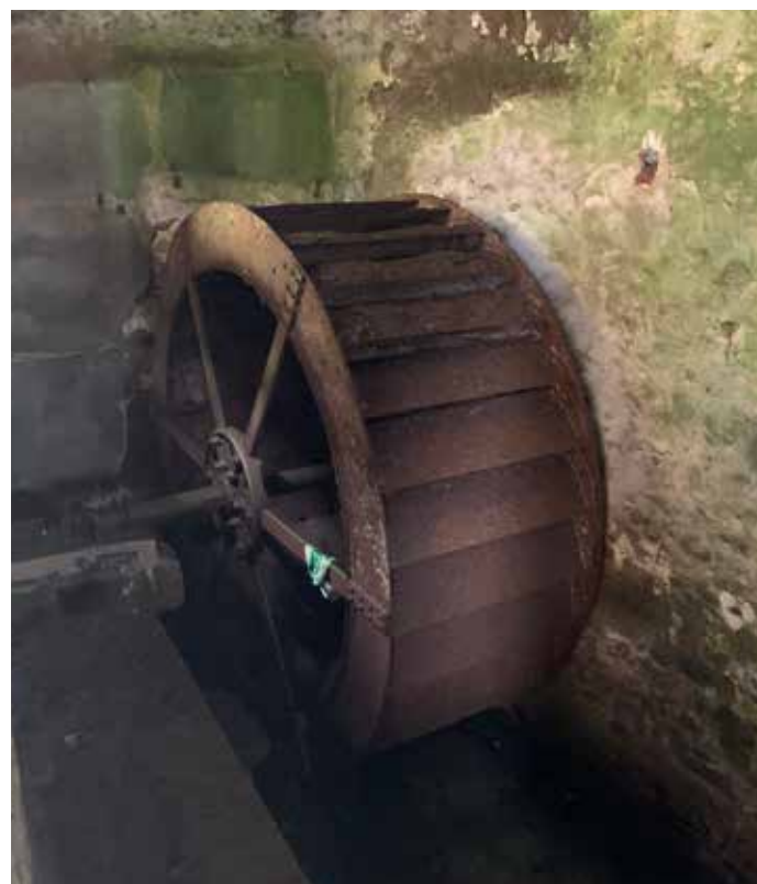
Ruota 1, diametro 305cm, spessore 118cm
