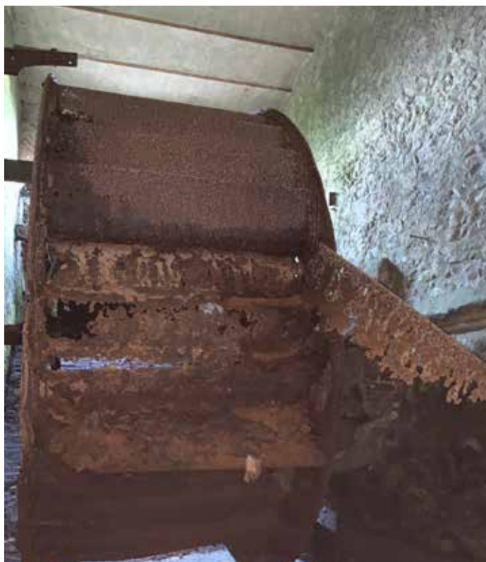
Ruota 2, diametro 350cm, spessore 145cm
